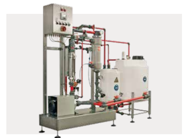
Spezialfilter für Spezialitätenessige | Filter for speciality vinegars (Kleinmengen) (small quantities)
